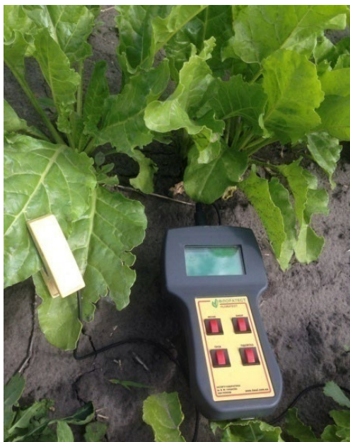
Рис. 4. Вимірювання інтенсивності флуоресценції хлорофілу приладом «Флоратест»
